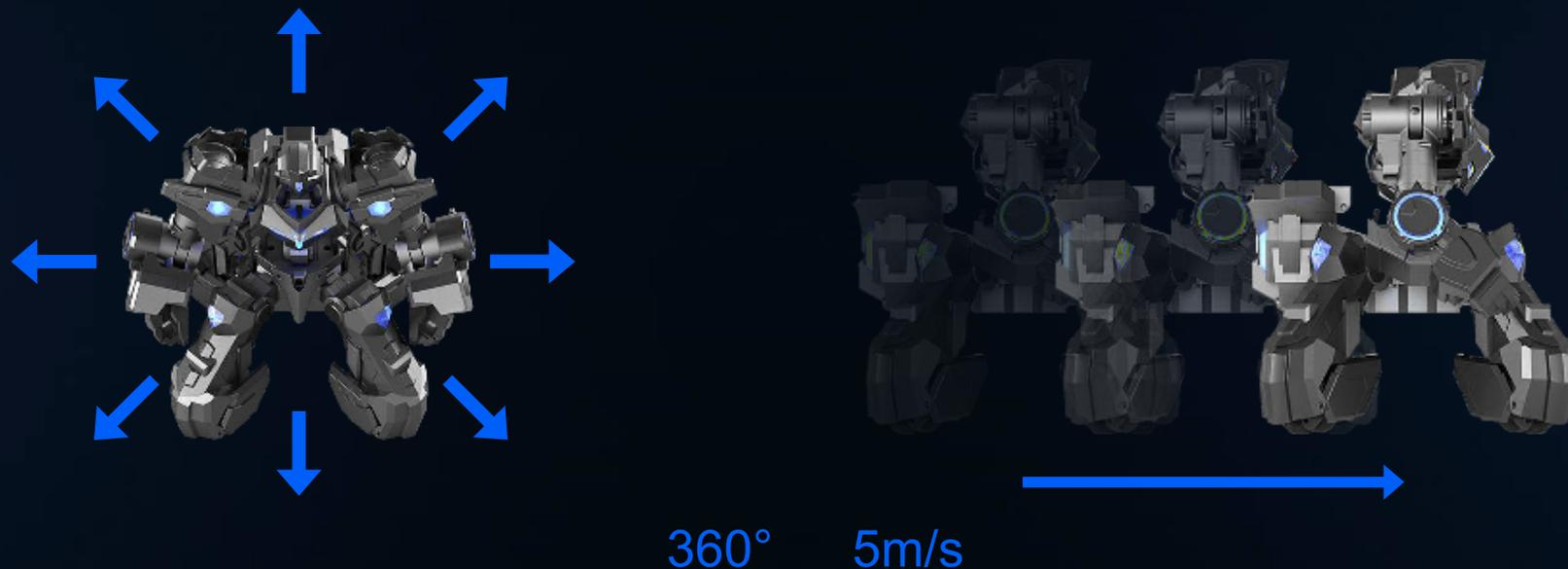
4 двигателя с вращающимися во всех направлениях опорными колесами обеспечивают высокоскоростное движение на 360° с максимальной скоростью 5 м/с. Модернизированная система шасси позволяет GANKER EX автоматически калибровать маршрут и двигаться точно.
